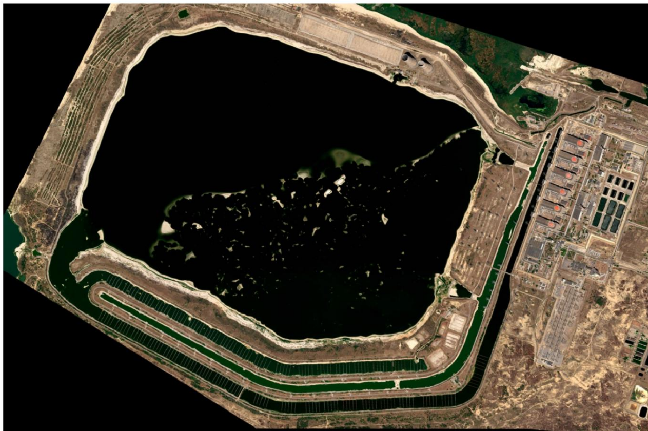
Image satellite de la centrale nucléaire de Zaporijia montrant les six réacteurs, le bassin de refroidissement, les canaux d'entrée et de sortie d'eau et le poste électrique (côté droit de l'image), le 12 août 2025. Source : © Airbus DS 2025
